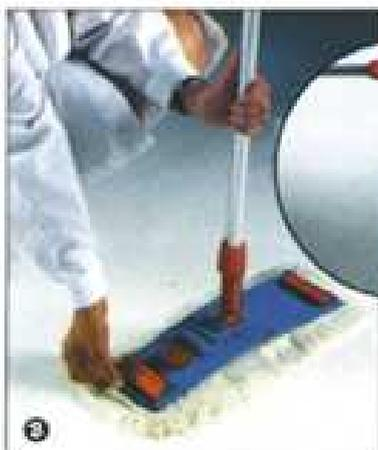
(2) Déposer le support **BSPE/A** sur la frange, en fixant les languettes.
